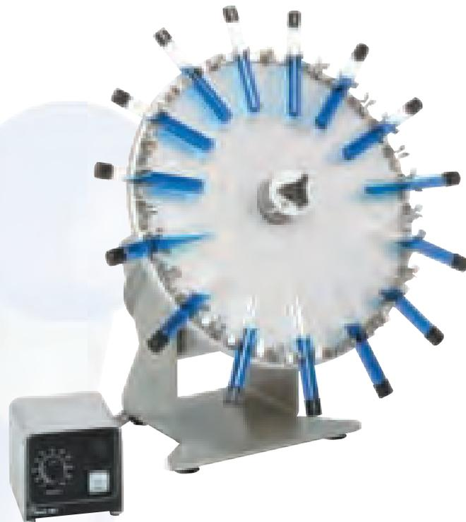
Il rotatore è di semplice utilizzo. Un dispositivo unico di bloccaggio utilizza l'azione di una leva per assicurare un mantenimento positivo della posizione del motore selezionata e permette di direzionarlo in ogni punto entro un arco di 110°.
