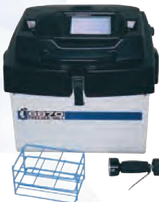
**Accessori del Mulino Criogenico 6870;** da sinistra: Estrattore/Apri Fiale per fiale di grande e media capacità 6804, Adattatore per fiale di media capacità 6884, Fiala di media capacità 6881.
