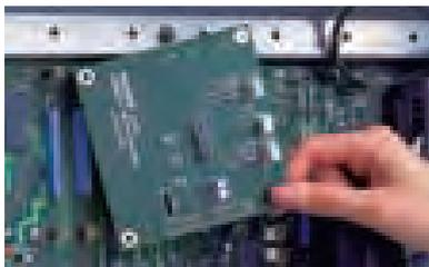
La scheda a microprocessore integrato assicura un controllo preciso e costante dei parametri ed è facilmente accessibile in caso di sostituzione o intervento tecnico.
