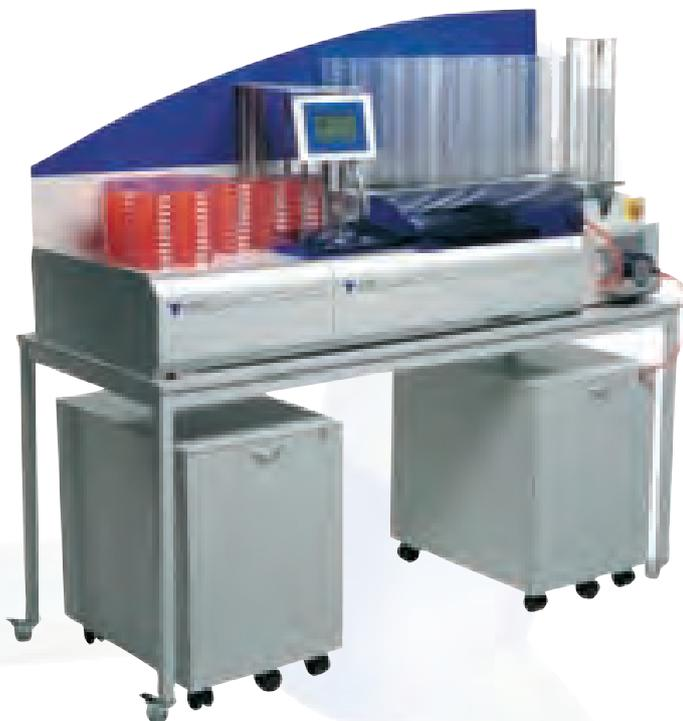
L'altezza delle pile di piastre può arrivare a 20 unità per ogni pila. Il nastro trasportatore può alloggiare fino a 400 piastre, che verranno riempite e accumulate in pile di altezza definita dall'utente.
